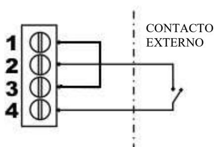
**ATENCIÓN:** una conexión incorrecta del contacto auxiliar podría provocar un cortocircuito en el circuito de baja tensión, ¡quemando el fusible! Tenga mucho cuidado cuando realice la conexión.
