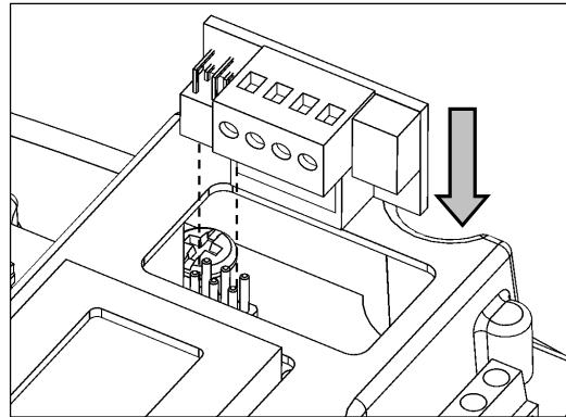
**UPOZORNĚNÍ:** Deska pomocných vstupů/výstupů je izolována od sít'ového napájení izolací „hlavního“ typu (základní izolace dle normy EN 60730-1). Jakýkoliv obvod, který bude připojen k této svorce, bude vyžadovat od sít'ového napájení stejnou kvalitu izolace. Z tohoto důvodu musí být zapojení provedeno za použití typu kabelu, který může zaručit doplňující izolaci.
