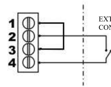
**LET OP:** een onjuiste aansluiting van het hulpcontact kan kortsluiting in het laagspanningscircuit veroorzaken, met als gevolg breuk van de zekering! Let gedurende de aansluiting goed op.
