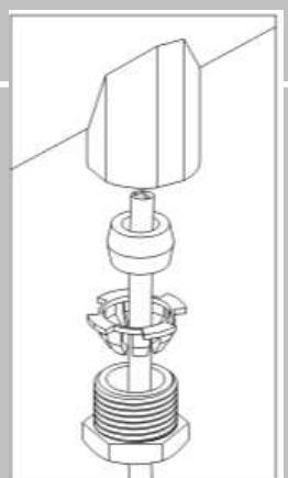
Die elektrischen Kabel in ihre Kabelhalter einführen und die korrekte Montagefolge aller Bestandteile beachten. Die Gewindemuttern ausreichend festziehen, damit die Kabel von außen nicht gezogen und gedreht werden können.
