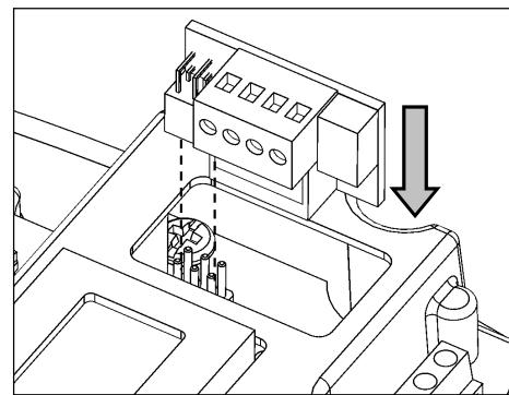
**LET OP:** De I/O hulpkaart is van het hoofdnet geïsoleerd via een isolatie van het type "hoofd" (basic insulation volgens EN 60730-1). Elk circuit dat is verbonden met deze klem zal dezelfde isolatiegraad verwerven ten opzichte van de netvoeding. Om deze reden moeten de aansluitingen tot stand worden gebracht met een type kabel dat aanvullende isolatie garandeert.
