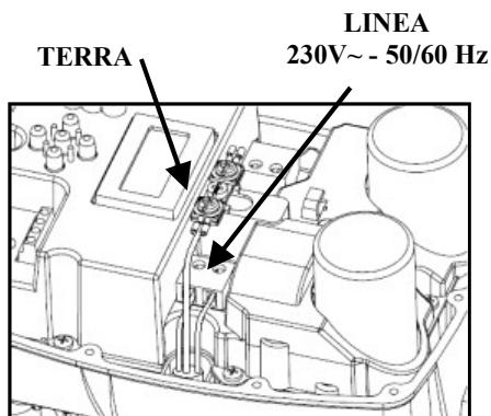
L'alimentazione del dispositivo è di tipo monofase a 230 Volt 50/60Hz.
