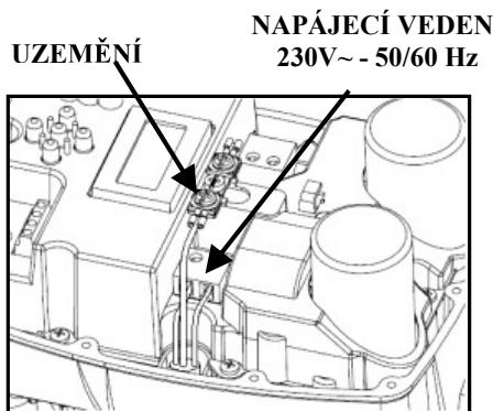
Zařízení má jednofázové napájecí vedení s parametry 230 Volt, 50/60 Hz. Elektrický systém, ke kterému je dané zařízení připojeno, musí splňovat platné bezpečnostní předpisy a musí proto být vybaven těmito prvky:
