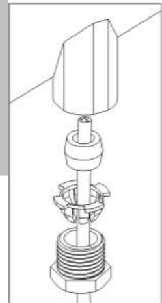
Introduzca los cables eléctricos en las borneras, asegurándose de mantener el orden correcto de montaje de todos los componentes. Apriete bien las tuercas roscadas para que los cables no puedan ser tirados ni girados desde afuera.
