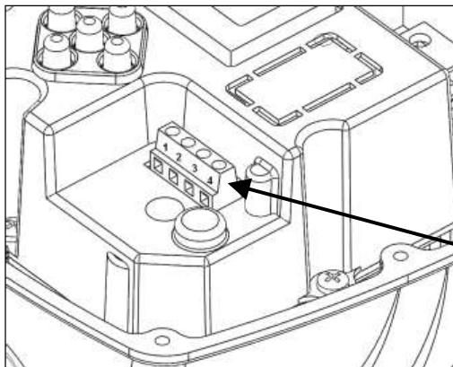
L’inverter è dotato di un connettore particolare tramite il quale è disponibile un contatto ausiliario per sfruttare funzionalità aggiuntive, interfacciando il dispositivo con altre apparecchiature esterne. La funzione svolta dal contatto ausiliario dipende dall’impostazione del parametro “Contatto Ausiliario” descritto al paragrafo relativo alla programmazione; di seguito vengono elencate le tre modalità configurabili, le relative funzioni e metodi di collegamento elettrico.
