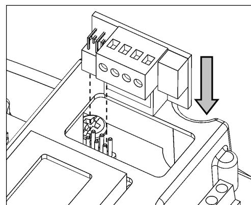
**ВНИМАНИЕ:** Дополнительная плата ввода-вывода изолирована от сети питания. Тип изоляции - «основной» (базовая изоляция согласно Европейским Нормам (EN) 60730-1). Любое устройство или контур, которые будут подключены к этому разъему, нуждаются в таком же уровне защиты. Поэтому соединение должно производиться кабелем такого типа, который бы гарантировал дополнительную изоляцию.
