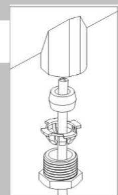
Namontujte elektrické vodiče do příslušných úchytek vodičů, přičemž se ujistěte, že je zachováno správné montážní pořadí pro všechny komponenty. Zajistěte dostatečně pevně závitové matice, aby se zabránilo vytažení vodičů nebo jejich ohýbání z vnější strany. Vodičová úchytka pro pomocný kontakt je slepý upevňovací prvek: budete-li chtít provést vložení vodiče dálkového ovládání, je vhodným postupem odstranit výše uvedenou matici z jednotky, poté silou pomocí šroubováku otevřete plastovou matici.
