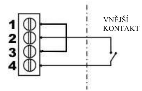
**⚠️ UPOZORNĚNÍ:** Nesprávné zapojení pomocného kontaktu může způsobit, že dojde ke zkratu nízkonapěťového obvodu s následným zásahem pojistky! Provedte zapojení se zvláštní péčí.
