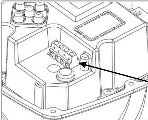
Invertoru je opatřeno speciálním konektorem pro pomocný kontakt, aby bylo možno využívat další funkce prostřednictvím rozhraní zařízení s externím přístrojovým zařízením. Funkce pomocného kontaktu závisí na nastavení parametru „pomocného kontaktu“ popsaného v odstavci o programování. Všechny tři provozní režimy, příslušné funkce a způsoby elektrického zapojení jsou popsány níže.
