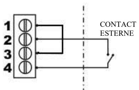
**⚠ ATTENZION:** une connexion erronée du contact auxiliaire pourrait provoquer un court-circuit dans le circuit en basse tension et, par conséquent, endommager le fusible! Prêter la plus grande attention lors du branchement.
