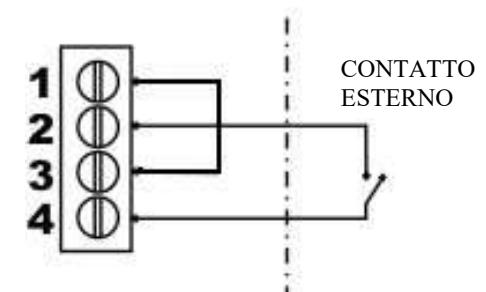
**ATTENZIONE:** un collegamento errato del contatto ausiliario potrebbe provocare un cortocircuito nel circuito in bassa tensione con conseguente rottura del fusibile! Prestare la massima attenzione durante il collegamento.
