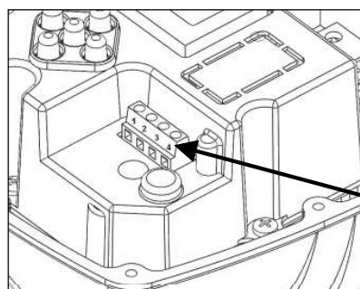
Устройство снабжено специальным разъемом для вспомогательного контакта, что позволяет устройству осуществлять дополнительные функции, когда к нему подсоединяют внешнее оборудование. Функции вспомогательного контакта зависят от настроек параметров «Вспомогательного Контакта», которые описаны в разделе «Программирование». Три рабочих режима, соответствующие функции и способы подсоединения описаны ниже.
