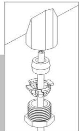
**Диаметр отверстия для кабельного уплотнения должен быть 7 мм.**
