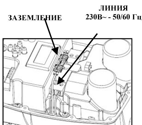
Устройство имеет однофазную 230 В 50/60 Гц. линию питания.
