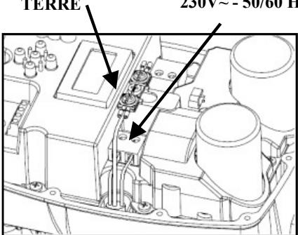
L'alimentation du dispositif est de type monophasée à 230 Volt 50/60Hz.
