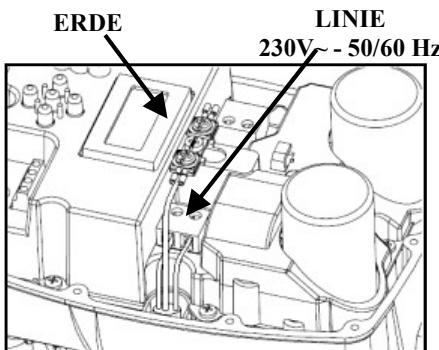
Die Versorgung der Vorrichtung ist einphasig 230 V 50/60Hz.
