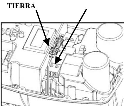
La alimentación del dispositivo es de tipo monofásica a 230 Voltios 50/60Hz.
