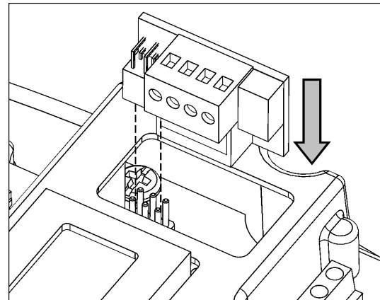
**PRECAUCIÓN:** La placa de E/S auxiliar está aislada de la red principal por medio de un aislamiento “general” (aislamiento básico según EN 60730-1). Cualquier circuito conectado a este borne adquirirá la misma clase de aislamiento respecto de la alimentación de red. Por esta razón las conexiones deben hacerse con un tipo de cable que garantice el aislamiento adicional.
