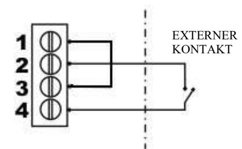
**⚠ ACHTUNG:** Eine falsche Verbindung des Hilfskontakte kann einen Kurzschluss im Niederspannungskreis mit darauf folgendem Durchbrennen der Sicherung auslösen! Beim Anschluss ist deshalb höchste Aufmerksamkeit erforderlich.
