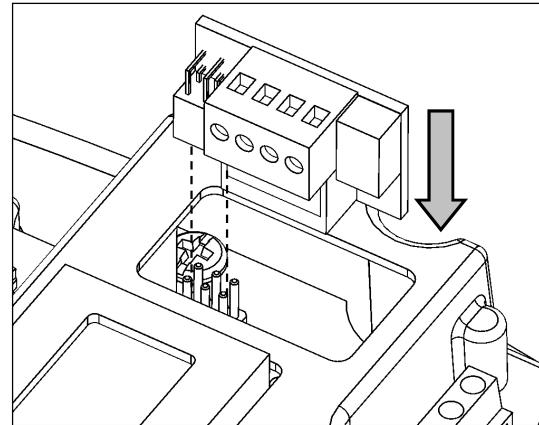
**ATTENTION:** La carte E/S auxiliaire est isolée du réseau électrique par un disjoncteur principal (basic insulation selon la norme EN 60730-1). Tout circuit branché à cette borne aura le même degré d'isolation que le réseau d'alimentation. De ce fait, les branchements doivent être effectués avec un type de câble garantissant une isolation supplémentaire.
