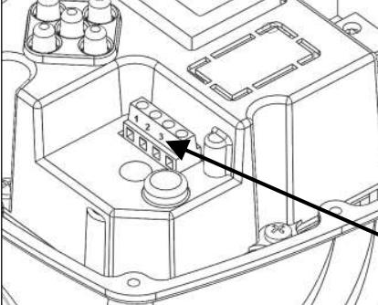
**LET OP:** De afstandsconnector is van het hoofdnet geïsoleerd via een isolatie van het type “hoofd” (basic insulation volgens EN 60730-1). Elk circuit dat is verbonden met deze klem zal dezelfde isolatiegraad verwerven ten opzichte van de netvoeding. Om deze reden moeten de aansluitingen tot stand worden gebracht met een type kabel dat aanvullende isolatie garandeert.
