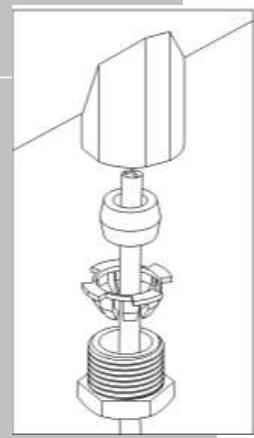
Il pressacavo per il contatto ausiliario è cieco: se si desidera inserire un cavo per il comando a distanza è opportuno sfondare il dado in plastica tramite un cacciavite dopo aver rimosso il dado stesso dall'unità.
