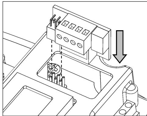
**ATTENZIONE:** La scheda I/O ausiliaria è isolata dalla rete principale tramite un isolamento di tipo “principale” (basic insulation secondo EN 60730-1). Qualsiasi circuito collegato a questo morsetto acquisirà lo stesso grado di isolamento rispetto all’alimentazione di rete . Per questo motivo i collegamenti devono essere eseguiti con un tipo di cavo che garantisca l’isolamento supplementare
