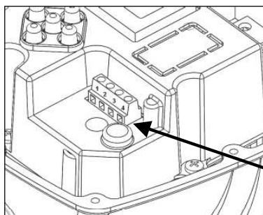
El variador incorpora un conector especial mediante el cual hay disponible un contacto auxiliar que permite aprovechar otras funcionalidades, conectando el dispositivo con otros equipos exteriores. La función del contacto auxiliar depende de la configuración del parámetro “Contacto Auxiliar” descrito en el párrafo relativo a la programación. A continuación se describen las tres modalidades configurables, sus funciones y los métodos de conexión eléctrica
