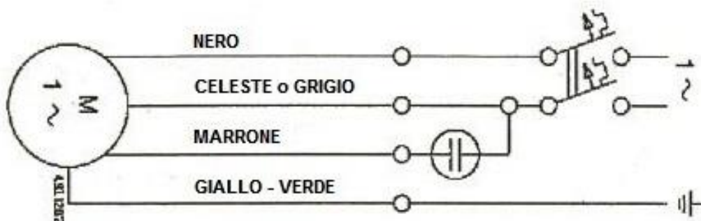
Schema di Collegamento Motori Monofasi
